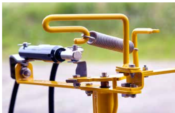
Hidraulinis pakraščių tręšimo valdymas
