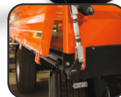
Naujoviškas kėbulo dugnas automatizuotai suvirintas iš 5 mm storio plieno lakštų. Šaltai valcuoti kraštai užtikrina tvirtumą ir gamybos tikslumą.
