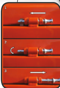
Naujoviška apatinio ir viršutinio šoninių bortų jungčių konstrukcija.
