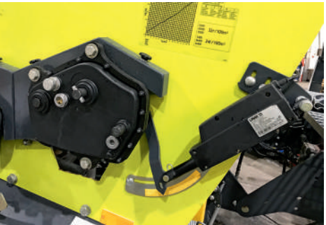
Savos konstrukcijos sėjamųjų ir tręšiamųjų aparatų sūkių keitimo mechanizmai – perdavų dėžės – sumontuotos dešiniajame sėjamosios šone. Standartiškai sūkiai reguliuojami mechaniškai (kairėje), tačiau papildomai galima užsisakyti patogesnę elektrinę nuotolinę tręšiamųjų (dešinėje) bei sėjamųjų aparatų sūkių reguliavimą. Tačiau reikia atminti, kad elektrinis tręšiamųjų aparatų sūkių keitimo mechanizmas galimas tik su „G-Wizard Plus“ ir „ISO-Bus“ valdymo terminalais, elektrinis abiejų, sėjamųjų ir tręšiamųjų aparatų sūkių keitimas – tik su „ISO-Bus“ terminalu
