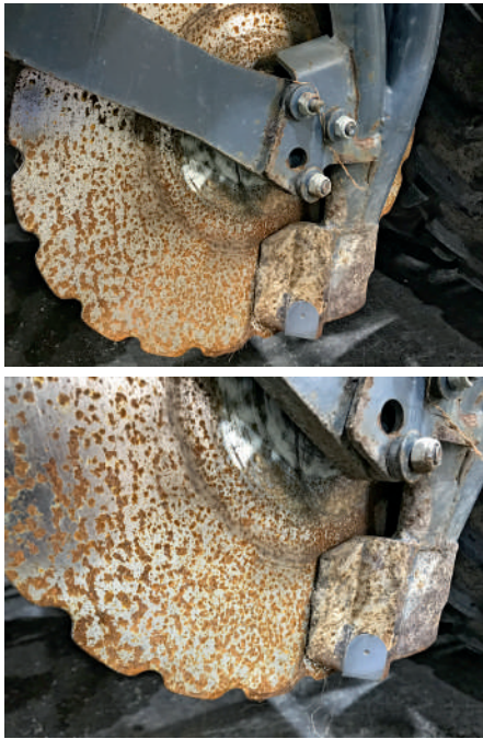
Diskinis M serijos noragėlis, kada trąšų įterpimui naudojamas vienas, tas pats noragėlis. M serijos sėjamosiomis galima sėti ir į visai neruoštą dirvą, tiesiai į ražieną, nes naudojami diskai su išpjaustytais ašmenimis, geriau pjaunantys ant dirvos paviršiaus esančias augalų liekanas. Svarbi detalė – labiausiai apkrautoje sėklavamzdžio antgalio apatinėje dalyje prilituota dilimui atspari kietlydinio plokštelė. Nuotraukoje 2014 m. pagamintos sėjamosios M300 Plus noragėliai
