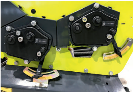
Savos konstrukcijos sėjamųjų ir tręšiamųjų aparatų sūkių keitimo mechanizmai – perdavų dėžės – sumontuotos dešiniajame sėjamosios šone. Standartiškai sūkiai reguliuojami mechaniškai (kairėje), tačiau papildomai galima užsisakyti patogesnę elektrinę nuotolinę tręšiamųjų (dešinėje) bei sėjamųjų aparatų sūkių reguliavimą. Tačiau reikia atminti, kad elektrinis tręšiamųjų aparatų sūkių keitimo mechanizmas galimas tik su „G-Wizard Plus“ ir „ISO-Bus“ valdymo terminalais, elektrinis abiejų, sėjamųjų ir tręšiamųjų aparatų sūkių keitimas – tik su „ISO-Bus“ terminalu
