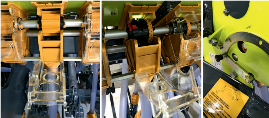
Trąšoms išberti naudojami ritiniai rievėti (kairėje), o juairaus stambumo sėkloms – ritiniai krumpļiniai kombinuojami sėjamieji aparatai (viduryje), sudaryti iš kelių, skirtingų matmenų krumpļiuotų ričių. Ritės tarpusavyje sujungiamos ir atjungiamos įstatant arba ištraukiant atskirai kaiščius (nuotraukoje jie raudonos spalvos). Kiekvienos ritės apačioje yra perstatomas dugnelis, kurio padėtis keičiama sėjamosios kairėje įrengta svirtimi. Iš viso yra keturios padėties: 0 arba dugneliai pakelti aukštyn – smulkios sėkloms, 3 arba nuleisti žemyn – stambioms sėkloms, pavyzdžiui, pupelėms
