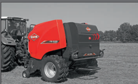
Vyksta rišimas tinkleliu, aktyvinami vizualūs ir garsiniai preso signalai.
