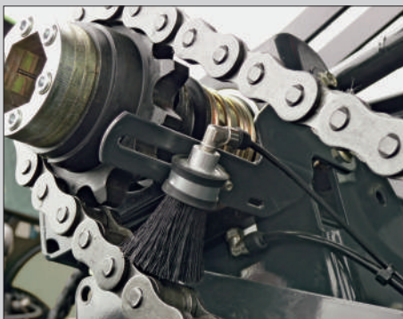
Tvirti ir platūs tepimo šepėčiai
