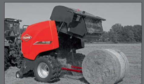
Ritinių stūmikliu yra nustatoma, kada ritinys yra nepasiekiamas. Daugiau galinis bortas nėra atidaromas. Galinis bortas uždarys automatiškai.
