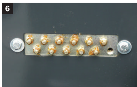
Automatinis grandinės tepimas ir centriniai volelių guolių tepimo taškai
