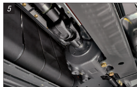
Sustiprintos varančiųjų tiltų skersinės svirtys
