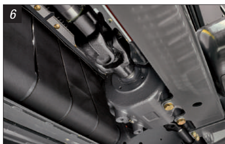
Sustiprintos varančiųjų tiltų skersinės svirtys
