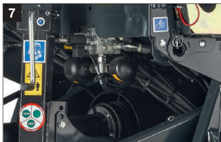
Proporcinis vožtuvas ritinio tankiui kontroliuoti iš kabinos – standartinė įranga
