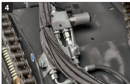
Atskiras peilių / grindų nuleidimo DROPFLOOR valdymas per terminalą
