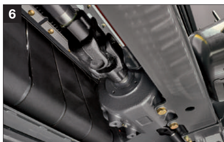
Sustiprintos varančiųjų tiltų skersinės svirtys
