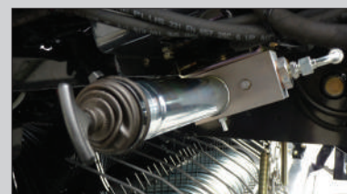
Automatinė guolių tepimo sistema „Beka Max“
