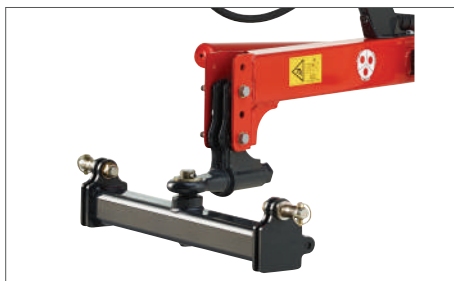
Dėl ilgo prikabinimo plotis / dideli traktoriai gali tempti vyniotuvą šonu
