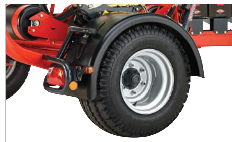
Dideli purvasaugiai apsaugo plėvelę nuo pažeidimų transportavimo metu
