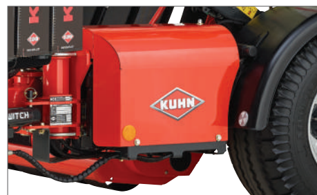
Dideliu šoniniu dangčiu yra saugoma hidraulinė sistema ir užtikrinama lengva prieiga techninei priežiūrai atlikti
