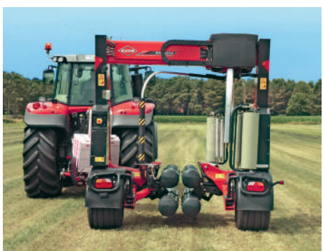
Vyniotuvo plotis siekia 2,5 m transportavimo metu ir 4 m dirbant lauke
