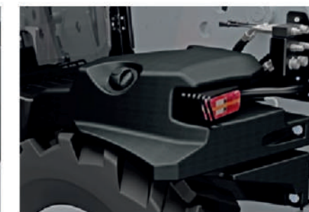
FS Compact modelio su žema kabina versijoje dyzelino bakas yra už kabinos.
