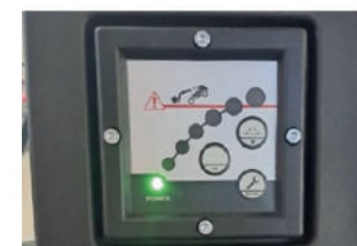
Apsaugos nuo apsisvertimo sistema, skirta 5 colių ekranams.
