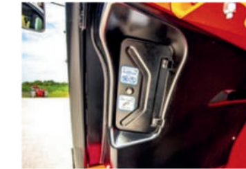
„AdBlue“ bakas apsaugotas plastiko gaubtu, kuris yra kabinos gale.
