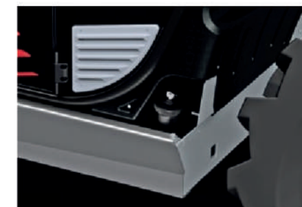
Degalų bakas, sumontuotas po kabina, užtikrina puikią apsaugą (standartinė versija).
