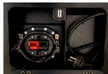
Įkrovimo stoties maitinimo lizdas, integruotas į 6.26 „Full Electric“.
