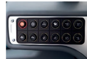
Prietaisų skydelio mygtukų panelė, platesnė „Big Range Full Electric“ modeliams.
