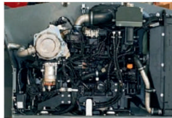
51,7 kW „Yanmar“ variklis, siūlomas „d.2d Small Range“ serijoje.
