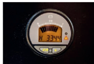
Baterijos stebėjimo sistema, įrengta jos priekinėje dalyje.
