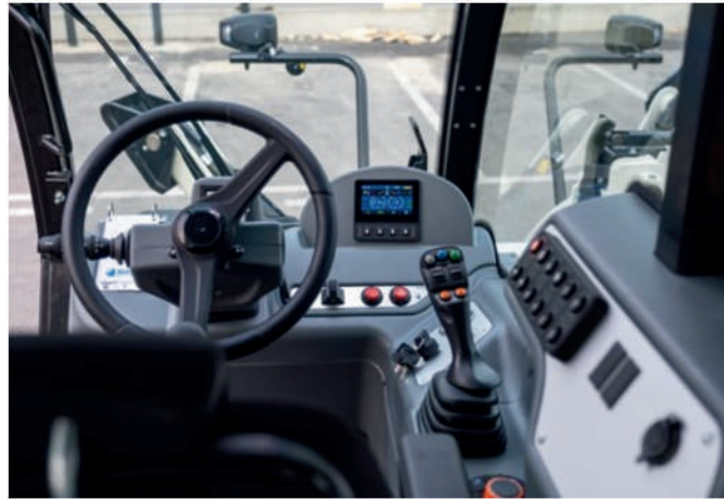
Kabina ir elektroproporcinis hidraulinis vairasvirtė yra standartinė įranga „Big Range Full Electric“ modelyje.
