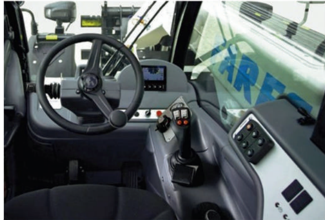
Kabina ir elektroproporcinis mechaninis vairasvirtė yra standartinė įranga modelyje „6.26 Small Range Full Electric“.
