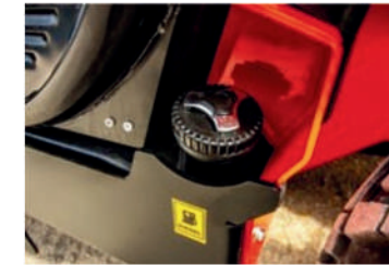
Dyzelinio bakas yra įrengtas užrakinamu dangteliu, kuris yra įrengtas kabinos apatinėje dalyje, siekiant užtikrinti puikią apsaugą.
