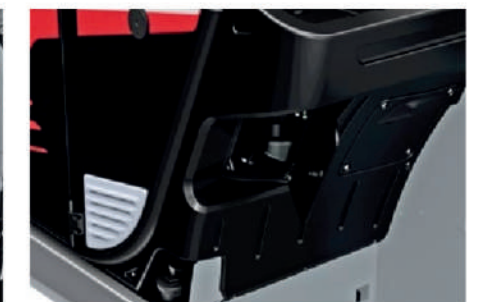
Varikliams su SCR sistema „Adblue“ bakas yra sumontuotas gale.
