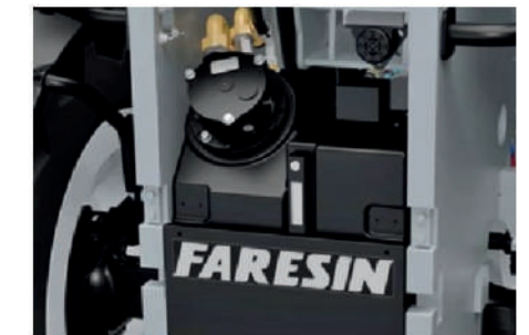
Hidraulinės alyvos bakas su alyvos lygio indikatoriumi.
