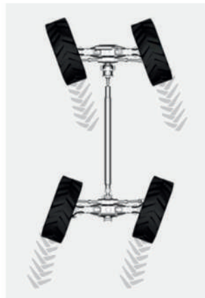
Koncentrinis: užtikrina mažesnį manevravimo spindulį.
