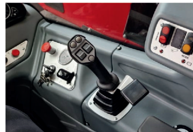
Elektrinis proporcinis hidraulinis daugiafunkcinis vairasvirtė, siūloma HLS ir VPSe versijose.
