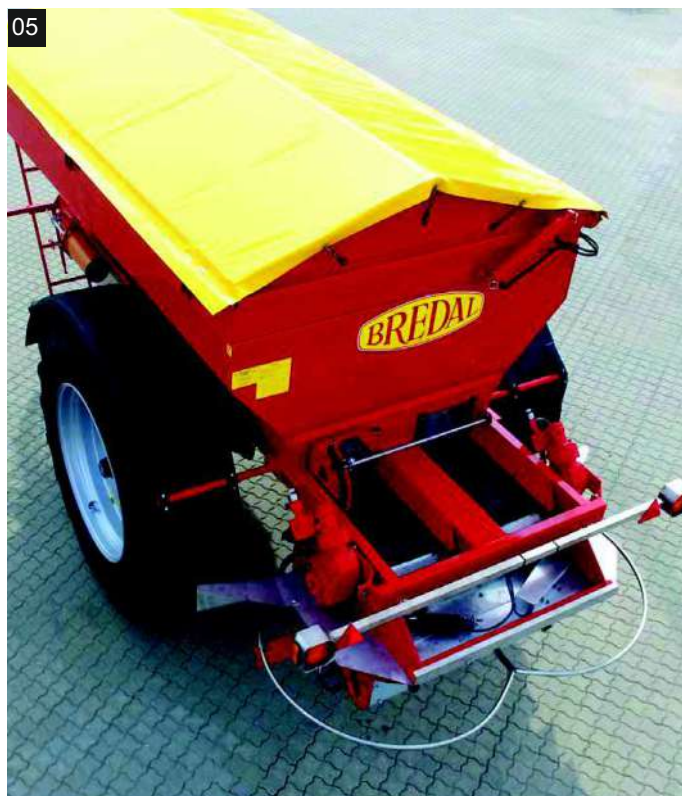
1. Barstomoji Bredal F8 2. Trąšų barstymo sistema su 2 diržiniais transporteriais, 2 galinėmis durimis ir 2 nepriklausomais skleidimo diskais 3. Eelektroniškai valdomos sklendės 4. Davikliai 5. F8 - vaizdas iš viršaus 6. Galinių durų matuoklė
