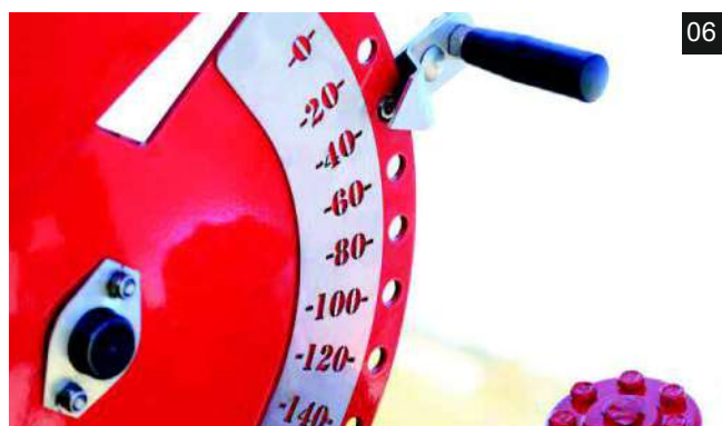
1. Barstomoji Bredal F8 2. Trąšų barstymo sistema su 2 diržiniais transporteriais, 2 galinėmis durimis ir 2 nepriklausomais skleidimo diskais 3. Eelektroniškai valdomos sklendės 4. Davikliai 5. F8 - vaizdas iš viršaus 6. Galinių durų matuoklė
