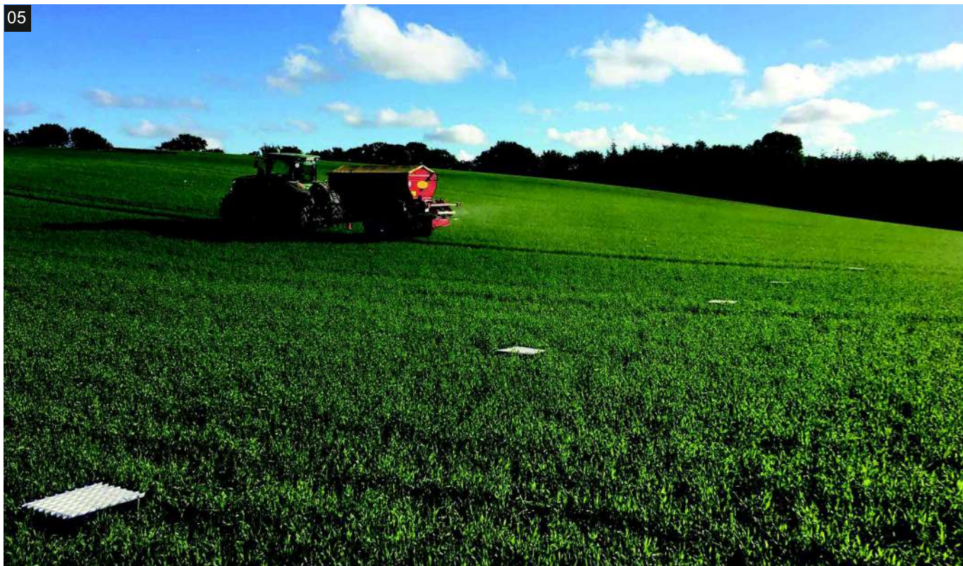
1. Talpa su sieteliu, skirta trašų dalelių dydžiui nustatyti 2. Kalibravimo rinkinys 3. Graduotas cilindras 4. „Bredal Test Kit“ bandymo rinkinį sudaro surinkimo padėklai (su pertvaromis), kalibruotas cilindras, piltuvėlis, gniuždymo stiprumo testeris ir sietelis 5. Trašų barstymo bandymas lauke su „Bredal“ bandymų rinkiniu (padėklai išdėstyti lauke).
