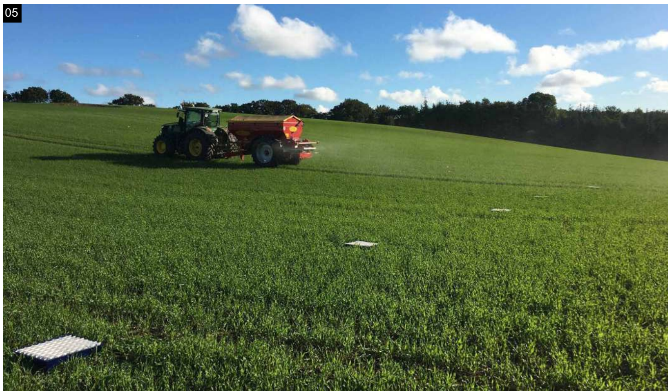
1. Talpa su sieteliu, skirta trąšų dalelių pasiskirstymui nustatyti 2. Kalibravimo rinkinys 3. Graduotas cilindras 4. „Bredal Test Kit“ bandymo rinkinį sudaro surinkimo padėklai (su pertvaromis), kalibruotas cilindras, piltuvėlis, gniuždymo stiprumo testeris ir sietelis 5. Trąšų barstymo bandymas lauke su „Bredal“ bandymų rinkiniu (padėklai išdėstyti lauke).
