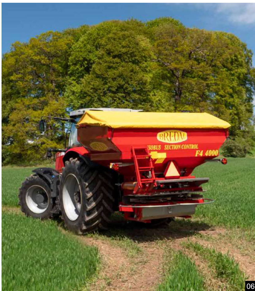
1. Diržinis transporteris dešinėje barstomosios pusėje 2. Nerūdijančio pleno išleidimo skląstis 3. Du svėrimo davikliai sumontuoti barstomojoje 4. Elektra valdomas užraktas 5. Sulankstomos kopėčios 6. Bredal F4 4000litrų talpos trąšų barstomoji
