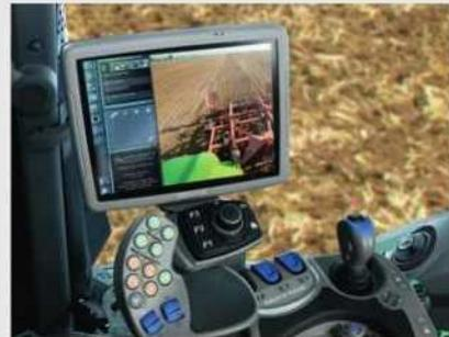
Integruota kamera su automatiniu vaizdo rodymu per visą ekraną (pvz. važiuojant atbulomis).
