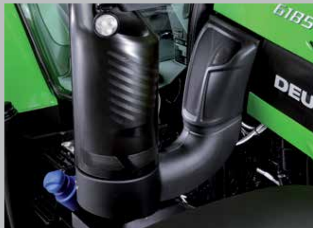
Pasyvusis suodžių filtras DPF kartu su selektyvinio katalitinio redukavimo katalizatoriumi SCR efektyviai mažina taršą, energijos sąnaudas bei taupo energijos išteklius.
