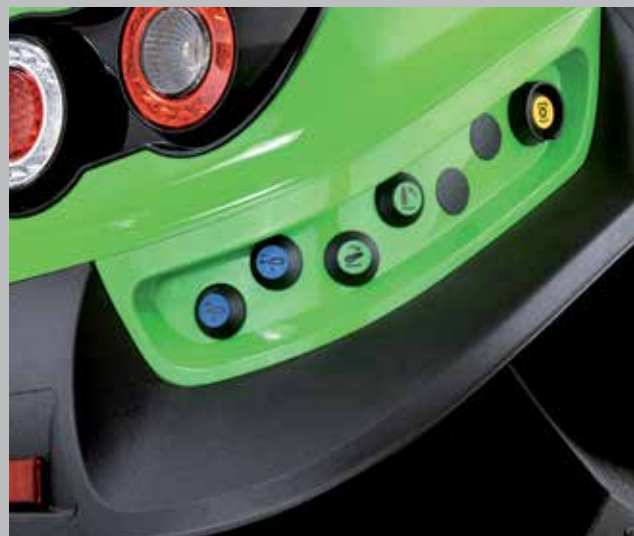
Išoriniai nuotoliniai hidraulikos, galinio keltuvo ir GTV valdikliai.
