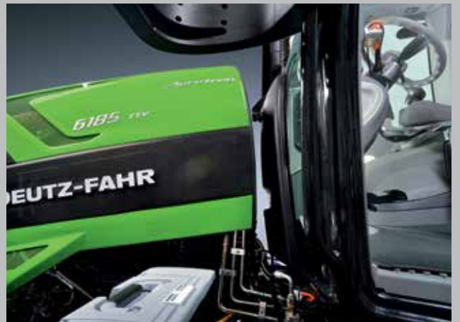
Nėra jungčių tarp kabinos ir variklio gaubto – didesnis komfortas traktorininkui.
