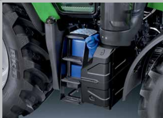
Mažesnės degalų ir tirpalo AdBlue sąnaudos. 280 l talpos dyzelino ir 35 l AdBlue bakas užtikrina ilgus darbo intervalus be sustojimų.
