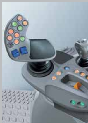
RCshift: visiškai nauja automatinė PowerShift transmisija optimaliam pavarų ir diapazonų perjungimui.
